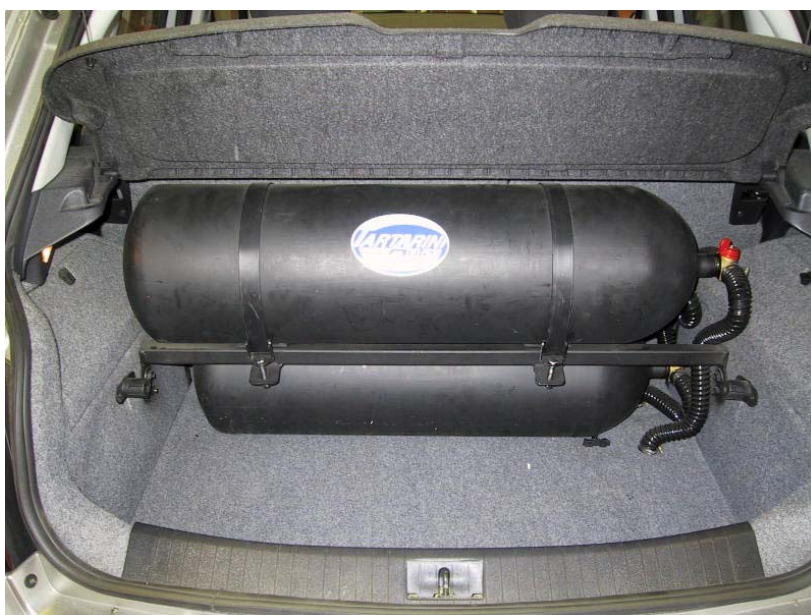
Installazione bombole metano.
