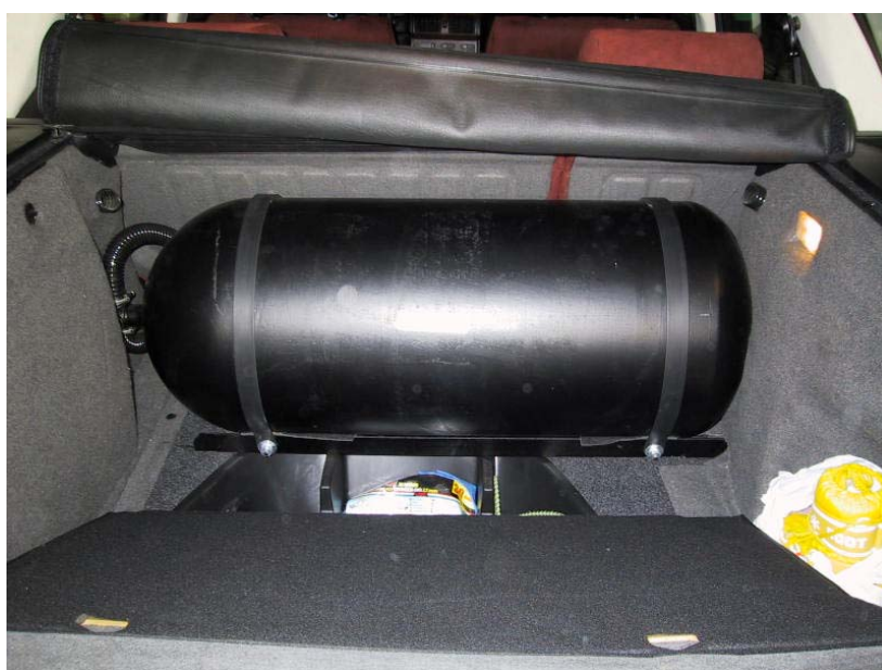
Installazione bombole metano.
