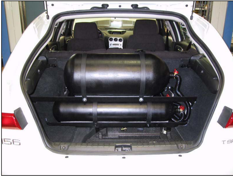
Installazione bombole metano.
