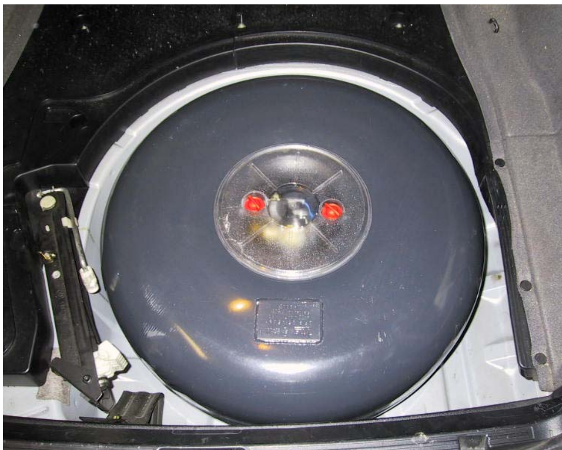
Installazione serbatoio del gas
