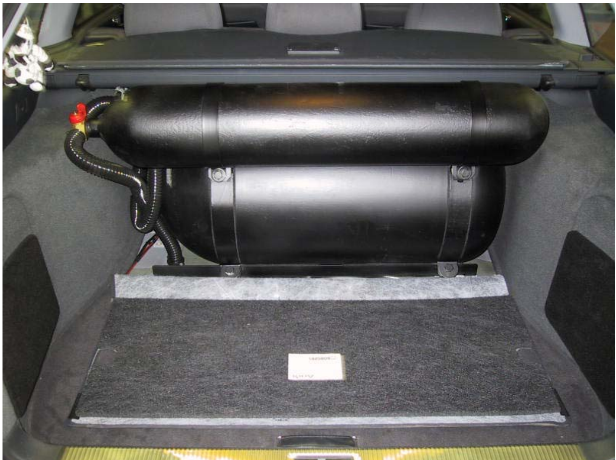
Installazione bombole metano.
