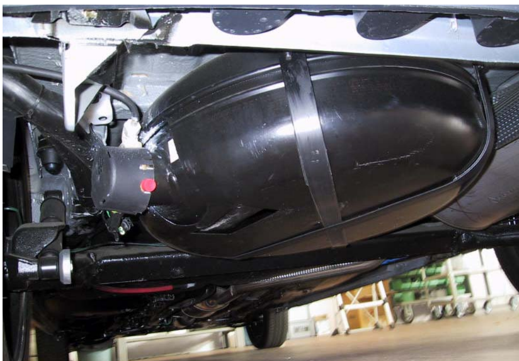
Installazione serbatoio del gas
