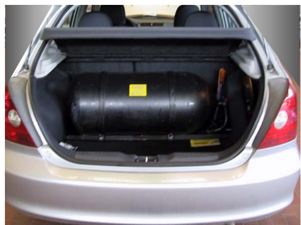
Installazione bombole metano
