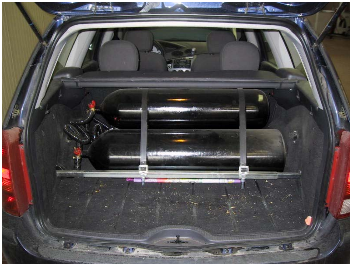
Installazione bombole metano.
