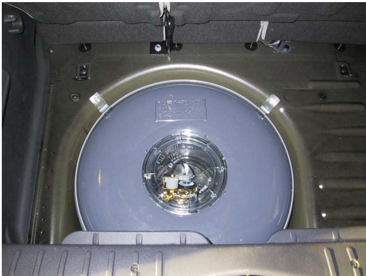
Installazione serbatoio del gas
