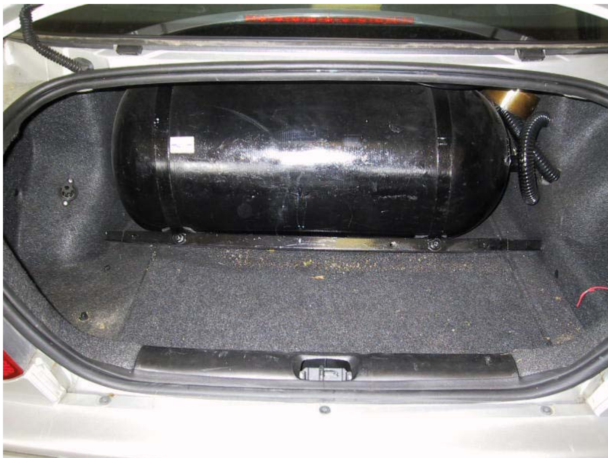
Installazione bombola metano.
