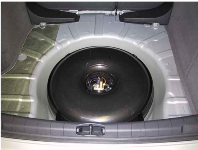
Installazione serbatoio del gas
