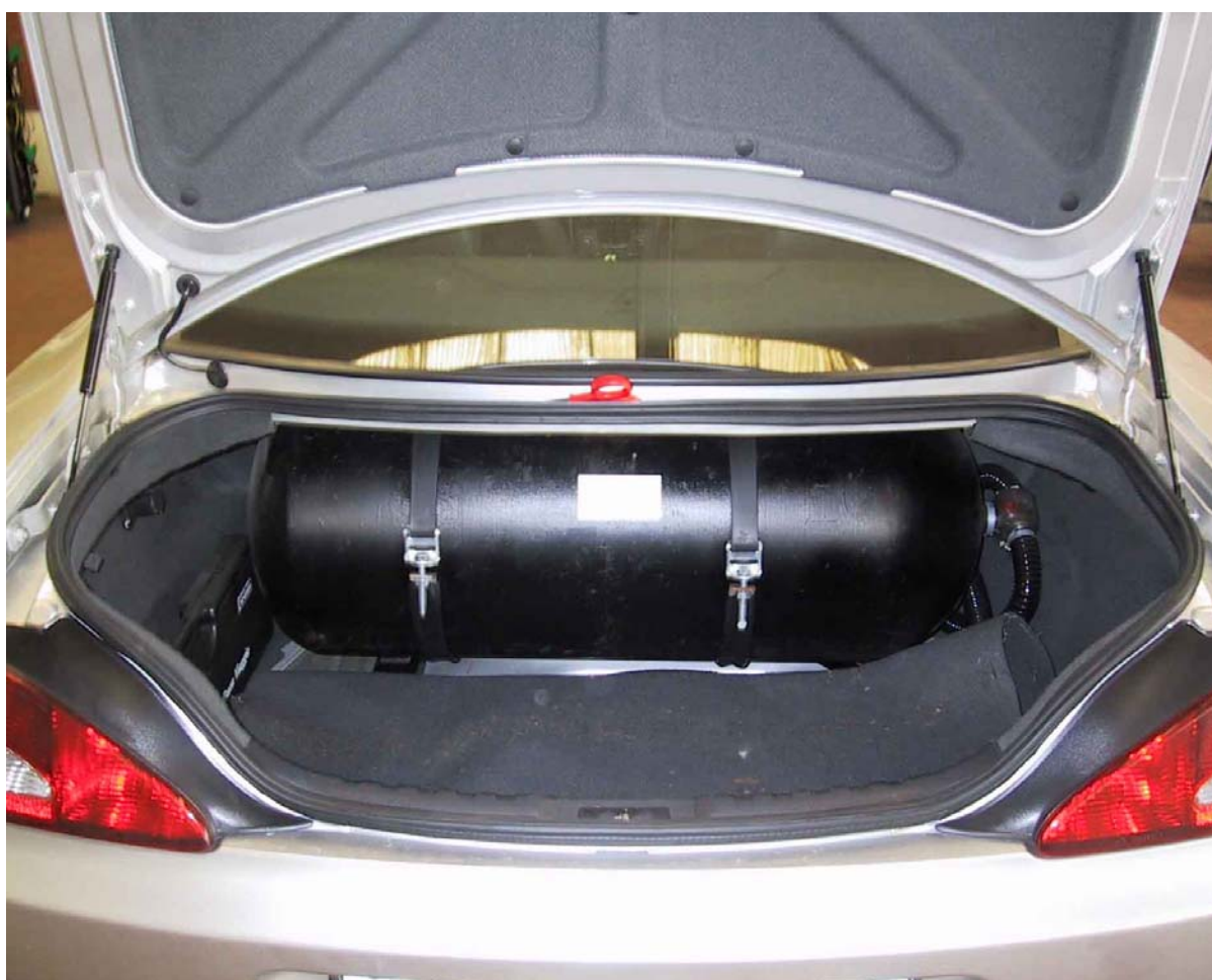
Installazione bombole metano
