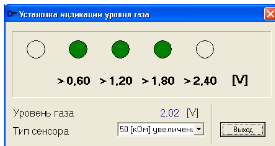
Рис. 3 Установка порогов светодиодов
